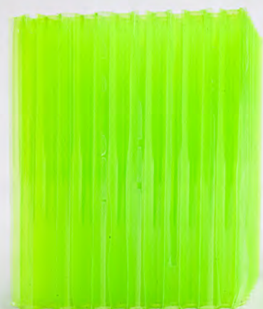
損傷していないセル (交換不要)
