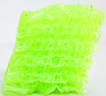
破損したセル (交換が必要)
