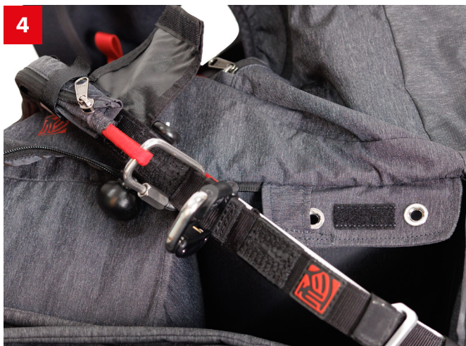
レスキュー ブライダルをスプレッダーのマイロン(レスキューリング)に接続して閉じます。
