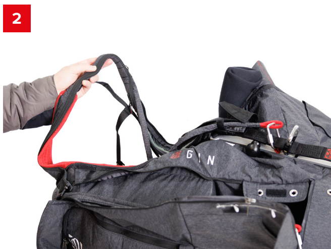
レスキューブライダルをジッパーブライダルトンネルに通し、ジッパーを最後まで閉じます。
